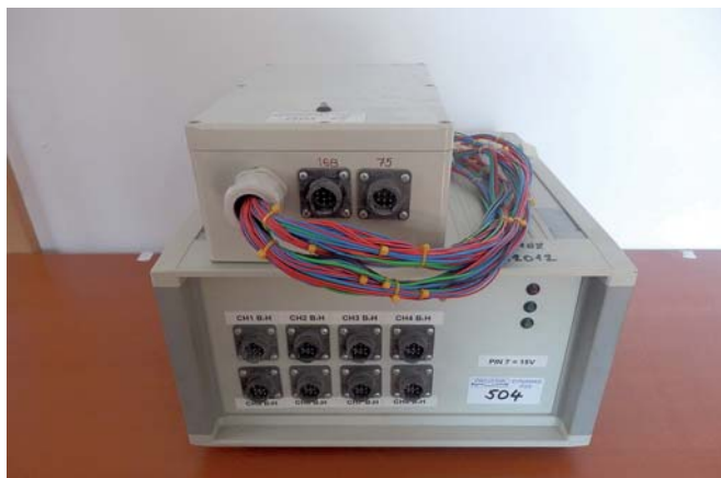
Obr. 5 Vľavo: 8-kanálová aparátúra Dynamag NT408 (šírka 325 mm), vpravo: prototyp 8-kanálovej aparátúry Triomag_8S s riadiacim počítačom Minix NEO Z83-4 Pro Fig. 5 On the left: 8-channel measuring device Dynamag NT408 (325 mm wide), on the right: a prototype of the 8 channel measuring device Triomag_8S with Minix NEO Z83-4 Pro
