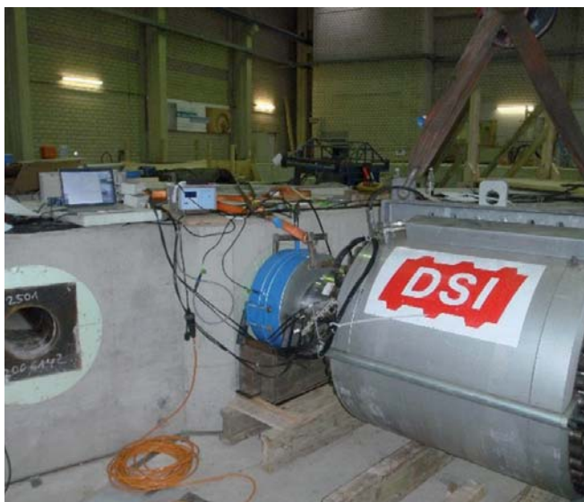
Obr. 4 Multilanový snímač pre 55 lán určený na zabudovanie do predpínacieho lisu PAUL TENSA. Snímač bol vyvinutý pre firmu DSI, Unterschleissheim, Nemecko. Fig. 4 Multi-strand sensor designed for 55 strands and intended for installation into the pre-stressing machine PAUL TENSA. The sensor was developed for the company DSI, Unterschleissheim, Germany.
