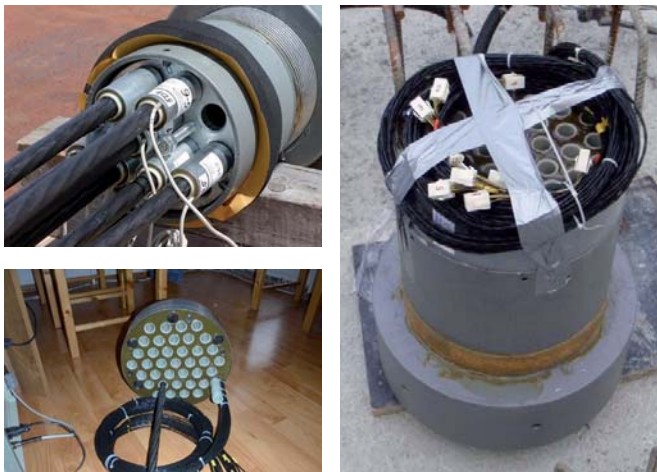
Obr. 3 Použitie jednonanových EM snímačov na meranie distribúcie sily medzi jednotlivé láná kábľa a ich náhrada multilanovým snímačom, ktorý je súčasťou kotvenia kábľa. Fig. 3 Use of the single-strand EM sensors for measuring the distribution of force between the individual strands of the tendon and their replacement by a multi-strand sensor, which is a part of tendon anchorage.
