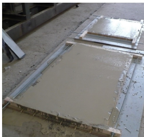
Obr.4 Betonáž vzoriek zo samozhutňujúceho betónu
