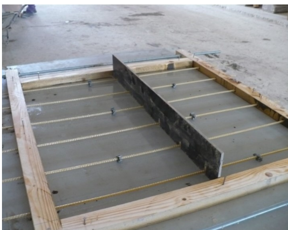
Obr.4 Betonáž vzoriek zo samozhutňujúceho betónu
