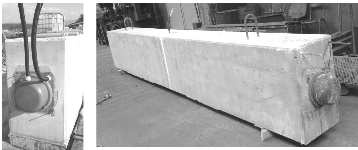
Obr.4 Skúšobný trám so zabudovaným EI 19- lanovým káblom PROJSTAR CH
