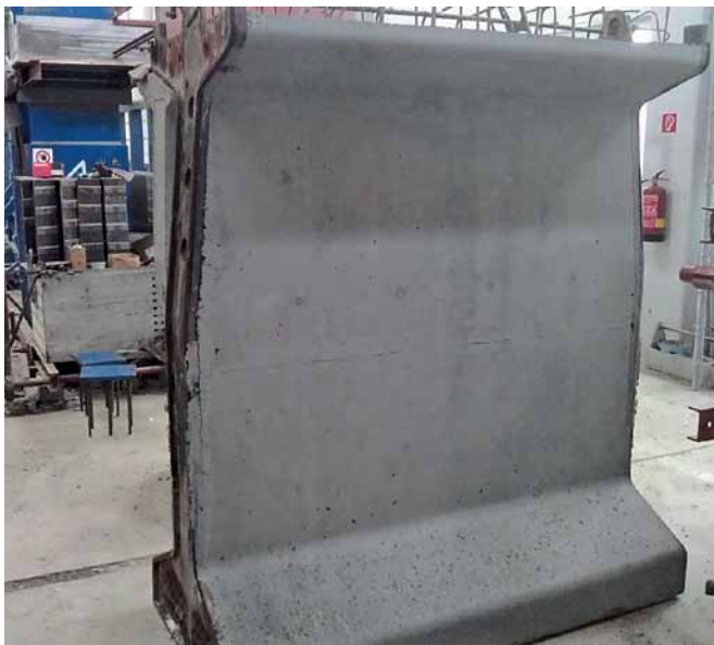
Obr. 3 Pohľad na skúšobný segment č. 2 vyrobený z betónu C 80/95 XC4, XD3, XF2 Fig. 3 Bottom view of test segment No. 2 made of C 80/95 XC4, XD3, XF2 concrete
