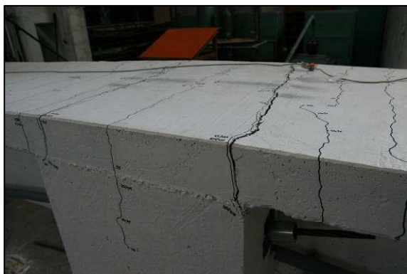
Obr. 9 Porušenie prierezu nad strednou podperou – horné vlákna betónu
