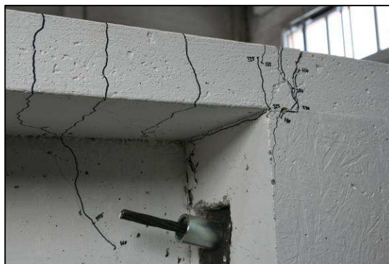
Obr. 9 Porušenie prierezu nad strednou podperou – horné vlákna betónu
