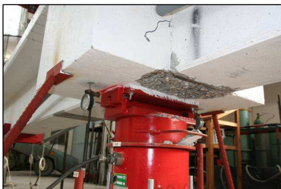
Obr. 10 Porušenie prierezu nad strednou podperou – spodné vlákna betónu
