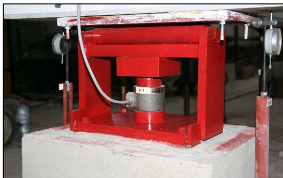
Obr. 3 Krajná podpera so silomerom PAUL a deviátor v strede poľa s EM snímačmi PSS20
