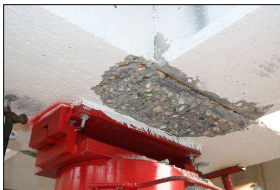
Obr. 10 Porušenie prierezu nad strednou podperou – spodné vlákna betónu
