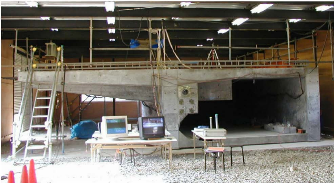
Obr.4 Skúška únosnosti kotevných blokov mosta SETOGAWA [6]
